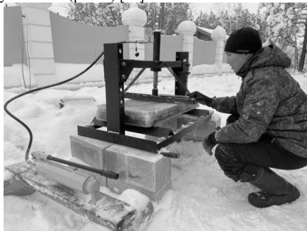
Рис. 1. Испытания фиброльда на трехточечный изгиб
